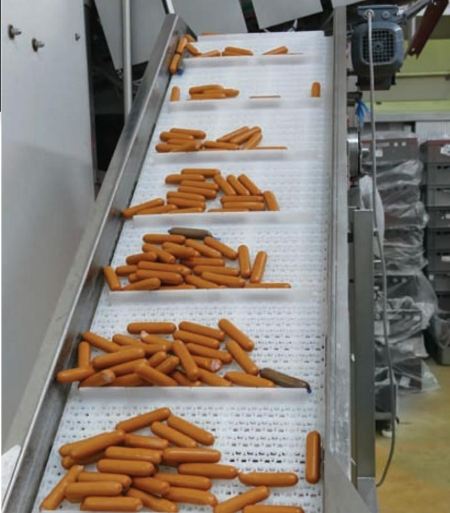
*Nach dem automatischen Peelen werden die teilweise noch mit Kunst Darmresten behafteten Würstel zur Sortieranlage gefördert.*
