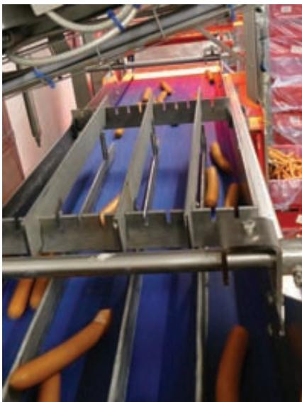
Je nach Produktgröße eingestellte Kaskaden richten die Würstel grob längs zur Förderrichtung aus.
