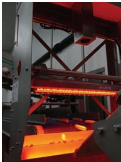
Mit 2 m/s fliegen die Würstel an der oberen und unteren Zeilenkamera vorbei. Beide Kameras sind in IP67-Schutzgehäusen montiert.
