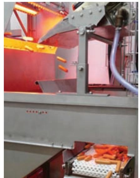
80 sehr schnelle Spezialventile blasen die mit Darmresten behafteten Produkte auf einer Breite von 400 mm punktgenau mit entkeimter Luft aus. Der Rest wird behutsam aufgefangen und dem weiteren Produktionsprozess zugeführt.
