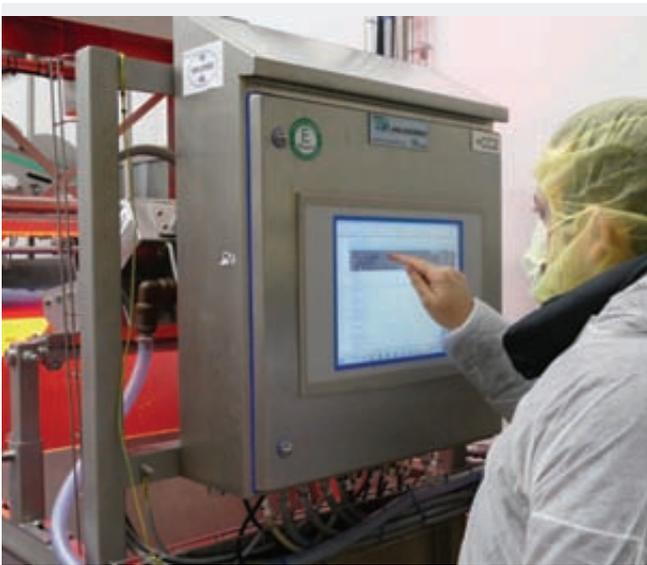
*Über den Touchscreen des integrierten Industrie-PCs in einem IP65-Schutzgehäuse kann die Anlage bedient werden.*
