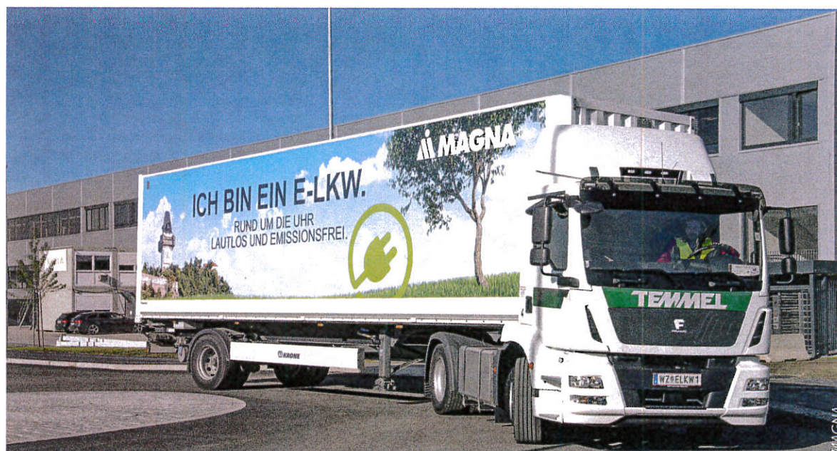
Der MAN-TGM-Diesel-Lkw wurde als Basis für den Elektro-Lkw herangezogen und mit einem elektrischen Antrieb versehen
