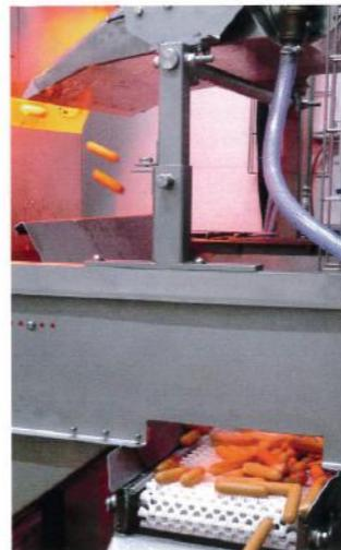
Spezialventile blasen Würstchen mit Darmresten punktgenau mit entkeimter Luft aus. Der Rest wird dem Produktionsprozess wieder zugeführt.
