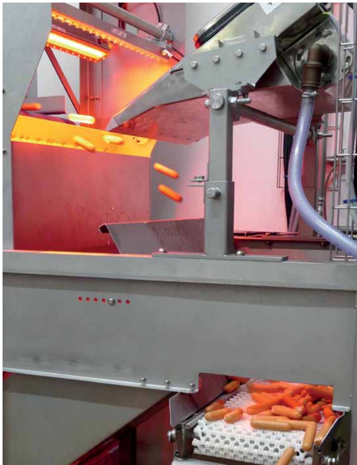
Die Würstchen fliegen zur Kontrolle an Zeilenkameras vorbei und werden beim Erkennen von Darmresten mit entkeimter Druckluft punktgenau weggeblasen
