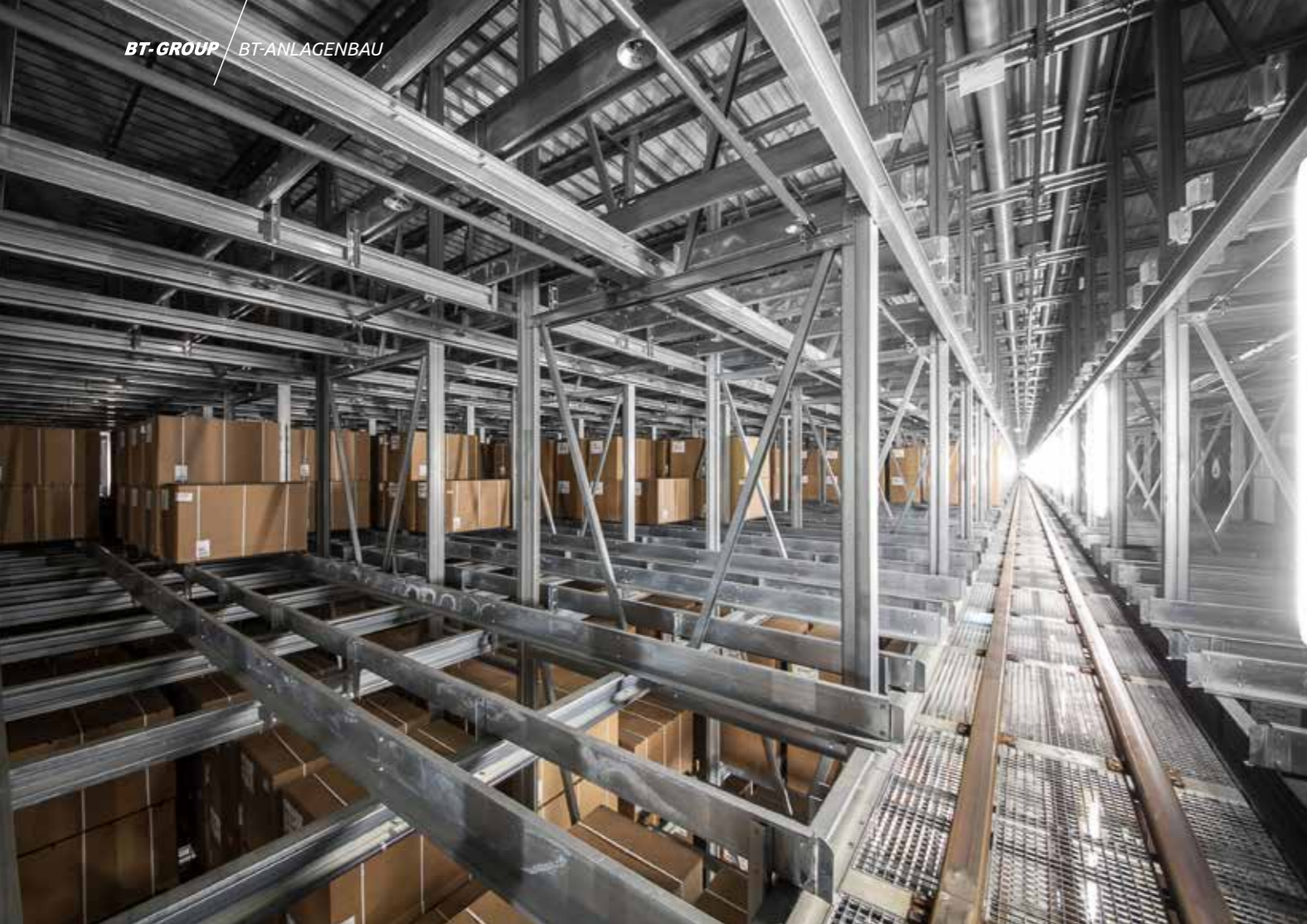
JTI Trier Rohtabaklager: 72.000 Lagerplätze auf über 2.000 Betonstopfsäulen (Einsatzraum der Hubtrolleys, zwei Ebenen werden mit nur einem Fahrzeug bedient) JTI tobacco warehouse, Trier: 72,000 storage positions, built over 2,000 concrete piles (picture shows where the trolleys work, two levels are handled by a single vehicle)
